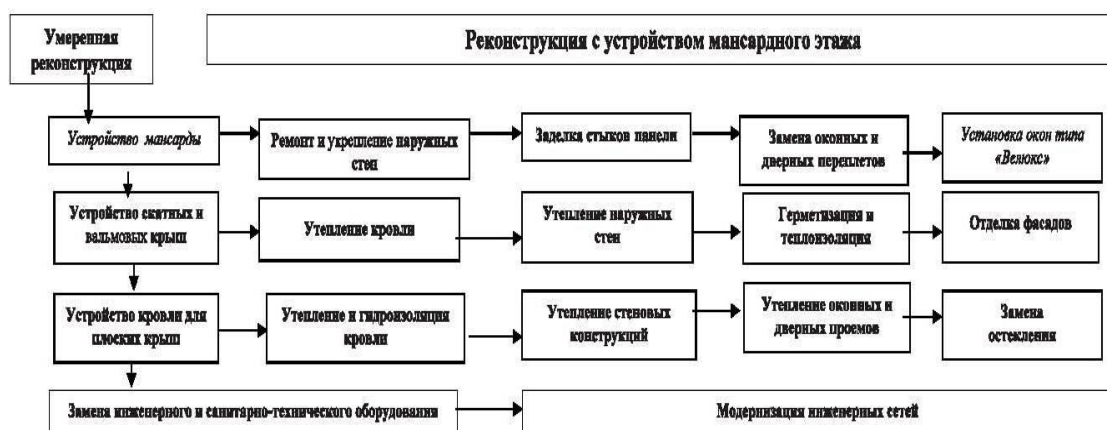
Рис. 2.1. Пример реконструкции жилого здания первого поколения с надстройкой мансардных этажей без расселения (жирным шрифтом выделены работы по капитальному ремонту)
