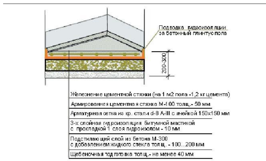
Рис. 11. Гидроизоляция пола подвала Защитная стяжка по слою бетона на полу подвала.
